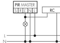
Bei Schaltung von netzparallelen Induktivitäten (Leuchtstofflampen, Schütze etc.) kann ein RC-Glied nötig sein.
