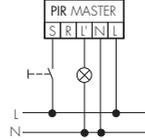
Mittels einem kurzen Tastendruck kann die Beleuchtung bei Bedarf manuell ein- bzw. ausgeschaltet werden.
