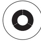
Drei separate Abdeckclips à 120° zur segmentweisen Reduktion der Reichweite auf je ca. 2,5 m Radius.
